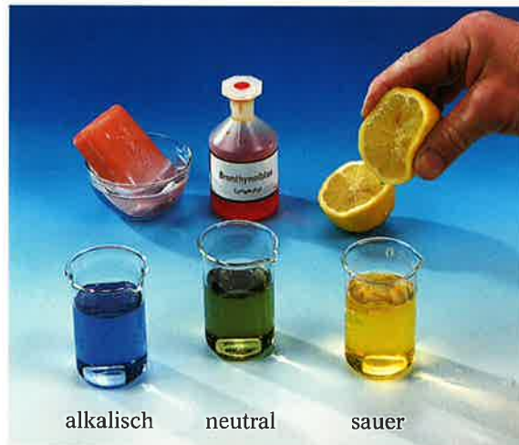
3 Indikatoren zeigen saure und alkalische Lösungen an
