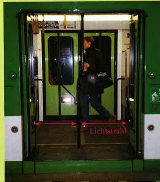
2 Lichtschranken steuern auch die Türen bei der Straßenbahn
